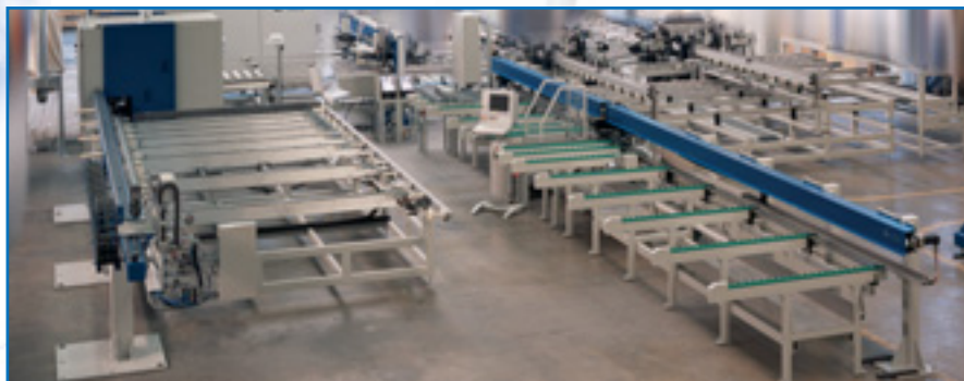
Stabbearbeitungsanlage mit Stahlzuschnittautomat
