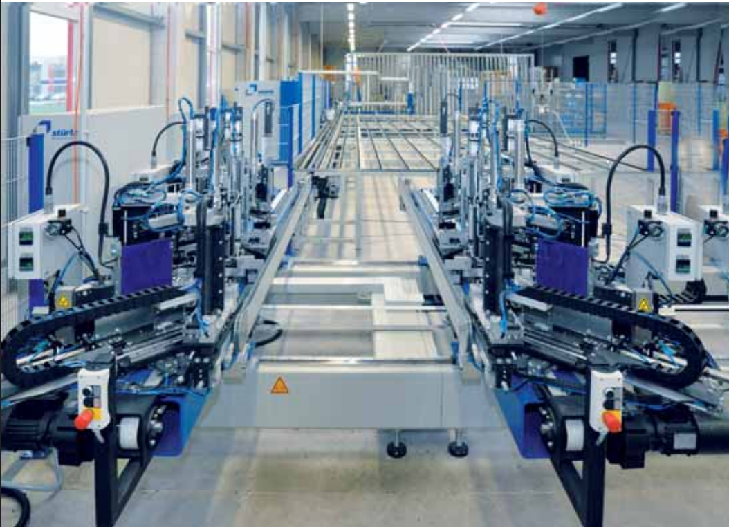
Die automatisierte Schweiß-/Putzlinie mit Wendestation bietet Raumökonomie und sorgt für hohe Produktivität und 1-A-Fertigungsqualität
