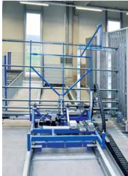
Automatische Ab Stapelung der Blendrahmen und Flügel in der Pufferstation.
