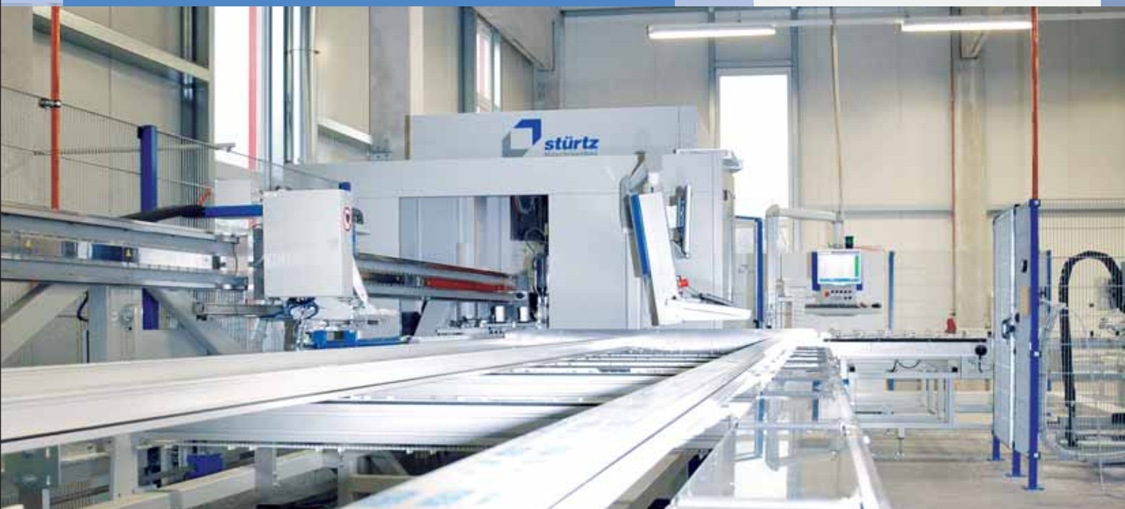
Das Stürtz-Stabbearbeitungszentrum für die komplette Bearbeitung von PVC-Fenster- und Haustürprofilen mit einer Produktionsleistung von 120 Fenstereinheiten pro Tag
