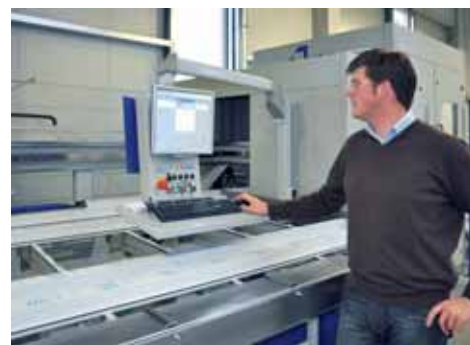
Manuel Peine wirft am Display des Stabbearbeitungszentrums einen Blick auf die Beladetabellenanzeige.
