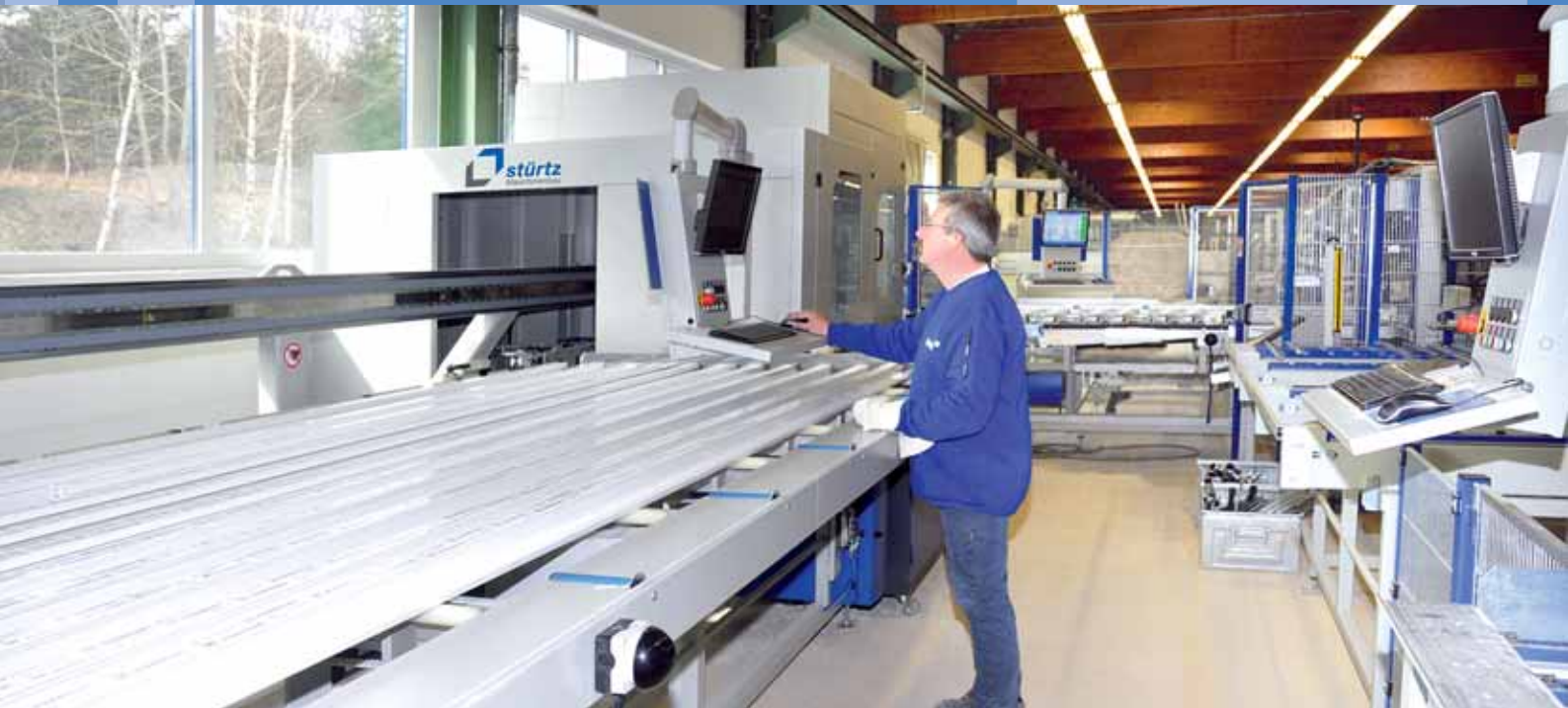
Die Stabbearbeitungsanlage mit automatischem Stahlzusschnittzentrum kann Profillängen bis 6,50 Meter verarbeiten und ist ausgelegt für bis zu 160 Fenstereinheiten pro Schicht.
