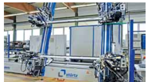
Eine der beiden neuen vertikalen 4-Kopf Schweißmaschinen mit Dichtungsniederhaltersystem, die bei Fenstern und Türen für höchste Perfektion sorgen.
