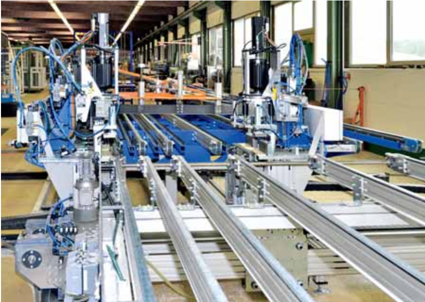
Die neue automatische Scherenecklager-Bohrstation, die taktzeitneutral an der geeigneten Stelle in den Produktionsablauf integriert wurde, spart Zeit und Personalkosten.
